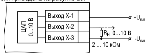
Рисунок 20 – Схема подключения нагрузки к ВУ типа У
