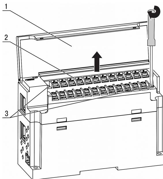
**Рисунок 8.1 – Отсоединение клемм**
