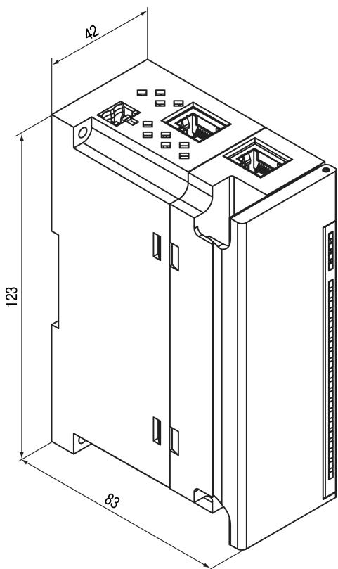
Рисунок 4.3 – Габаритный чертеж
