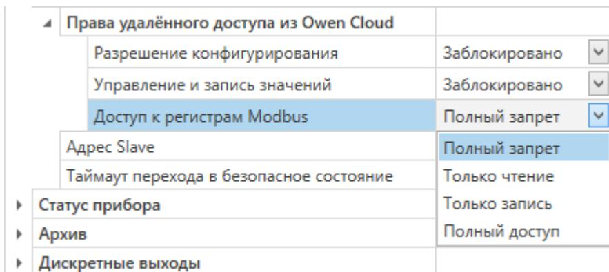
**Рисунок 7.4 – Настройка удаленного доступа к модулю**
