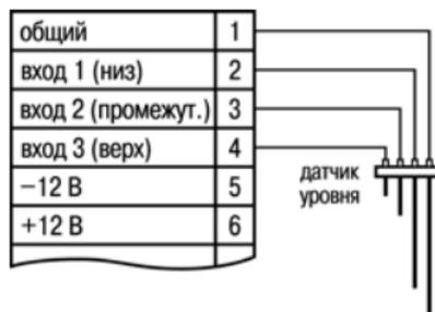
Рисунок 5.3 – Схема подключения кондуктометрических датчиков уровня
