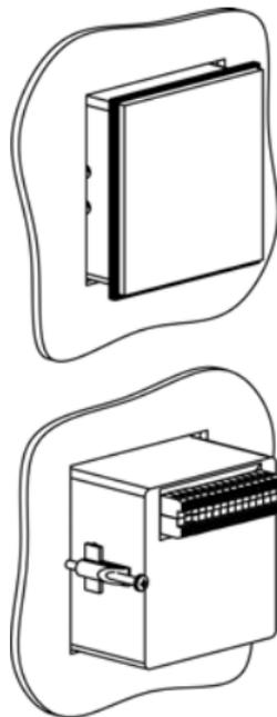
**Рисунок 4.3 – Монтаж прибора щитового крепления**
