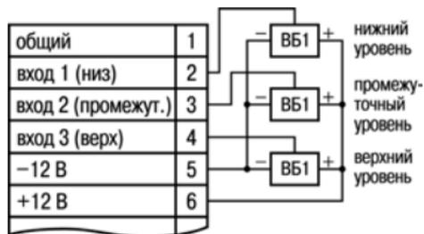
Рисунок 5.4 – Схема подключения емкостных переключателей
