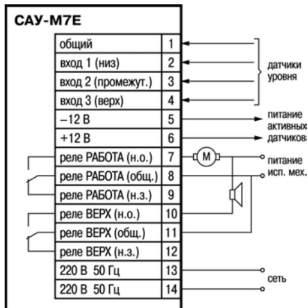
Рисунок 5.2 – Общая схема подключения САУ-М7Е
