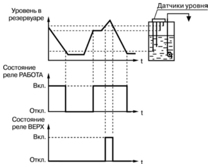
Рисунок 6.4 – Опорожнение резервуара по гистерезисному закону
