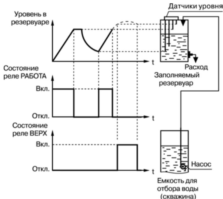
Рисунок 6.3 – Заполнение резервуара по гистерезисному закону
