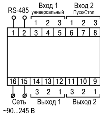
Рисунок 5.2 – Общая схема подключения TPM101
